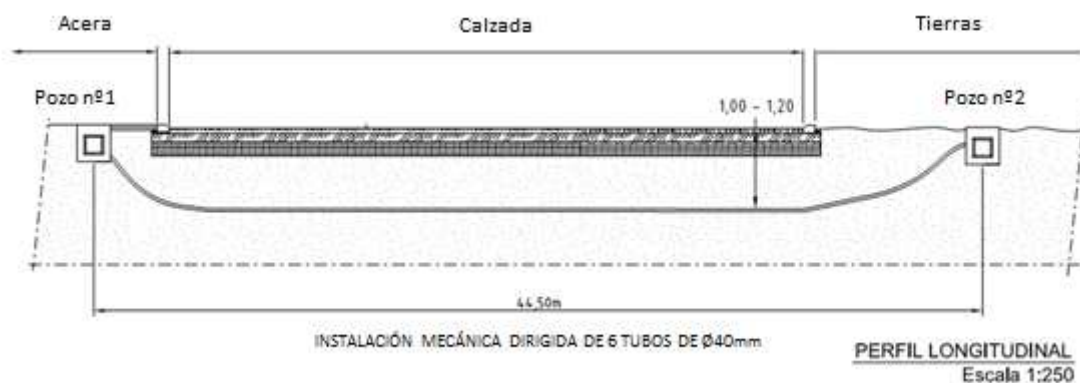
Figura 18. Ejemplo de perforación horizontal Topo.
